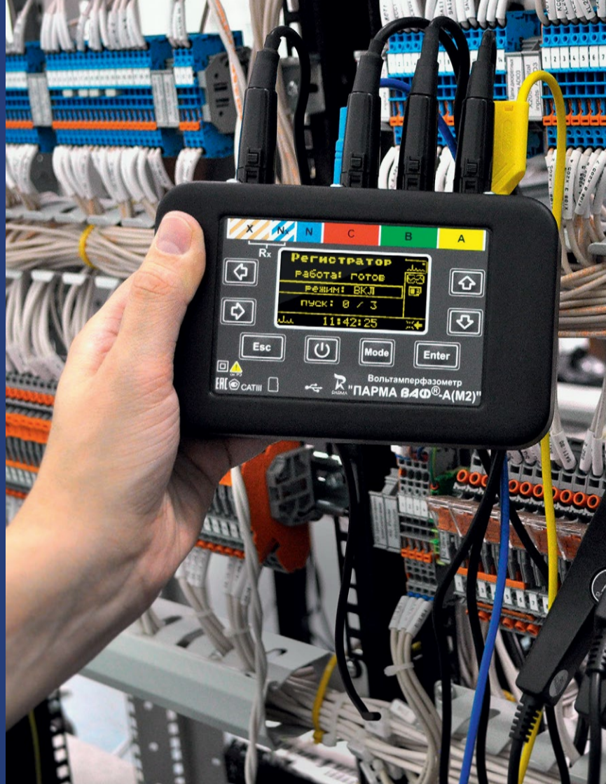
ДТИ-4 (от 10 до 1000 А) для измерения силы постоянного тока
